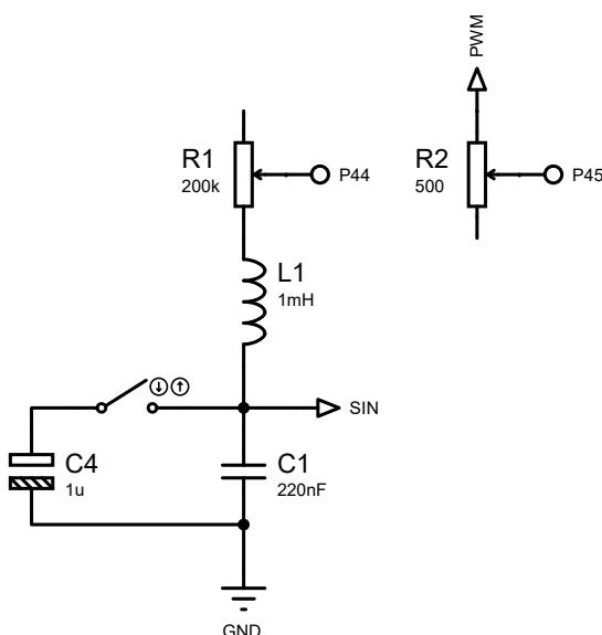
C4为可选项，在输出低频Sin时，连接C4；在输出高频Sin时，断开C4
