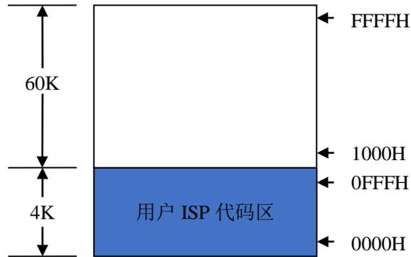
64K 的用户 FLASH，地址范围为 0000H~FFFFH，用户 ISP 代码会占据其中 0000H~0FFFH 的 4K 字节，剩余的 60K 字节的空间为用户程序区。当满足特定的下载条件时，用户 ISP 会根据上位机发送的指令对除 4K 用户 ISP 区以外的 60K 字节的 FLASH 进行擦除和编程，以达到更新用户程序的目的。
