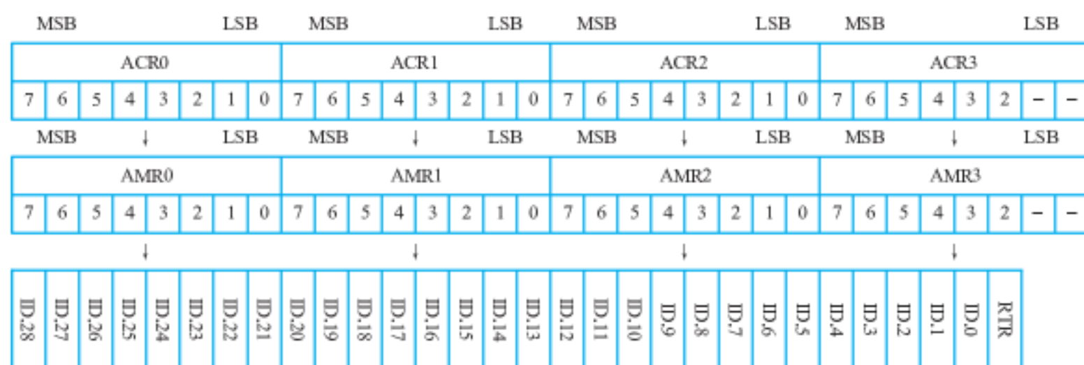
图 16.22 接收 CAN 扩展帧时单过滤器配置
