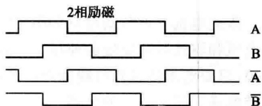
图 15-3 2 相励磁波形图
