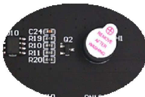
2 有源蜂鸣器电路部分实物照
