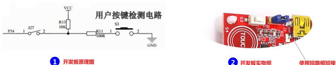
图 1：开发板按键检测电路及实物图
