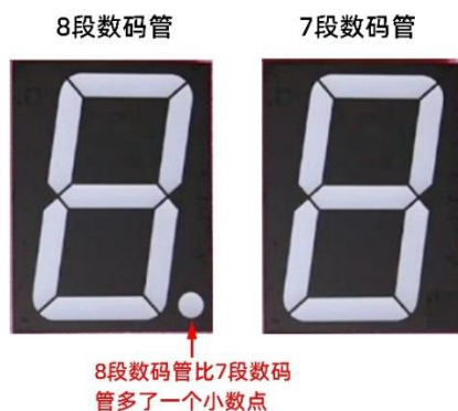
图 1：8 段数码管比 7 段数码管
