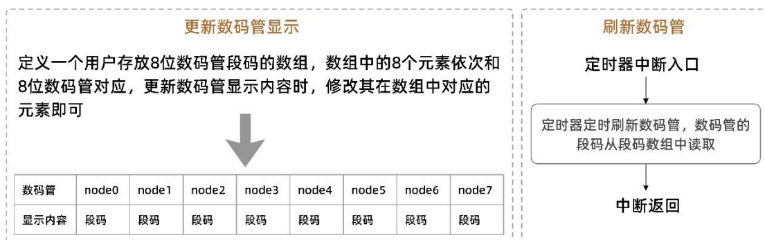
图 7：数码管软件驱动原理
