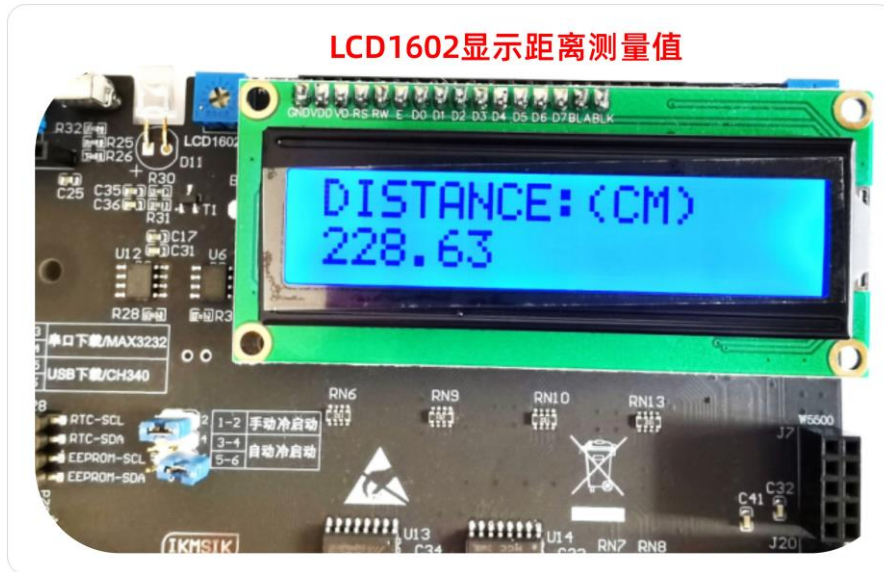
图 6: LCD1602 显示测量的距离
