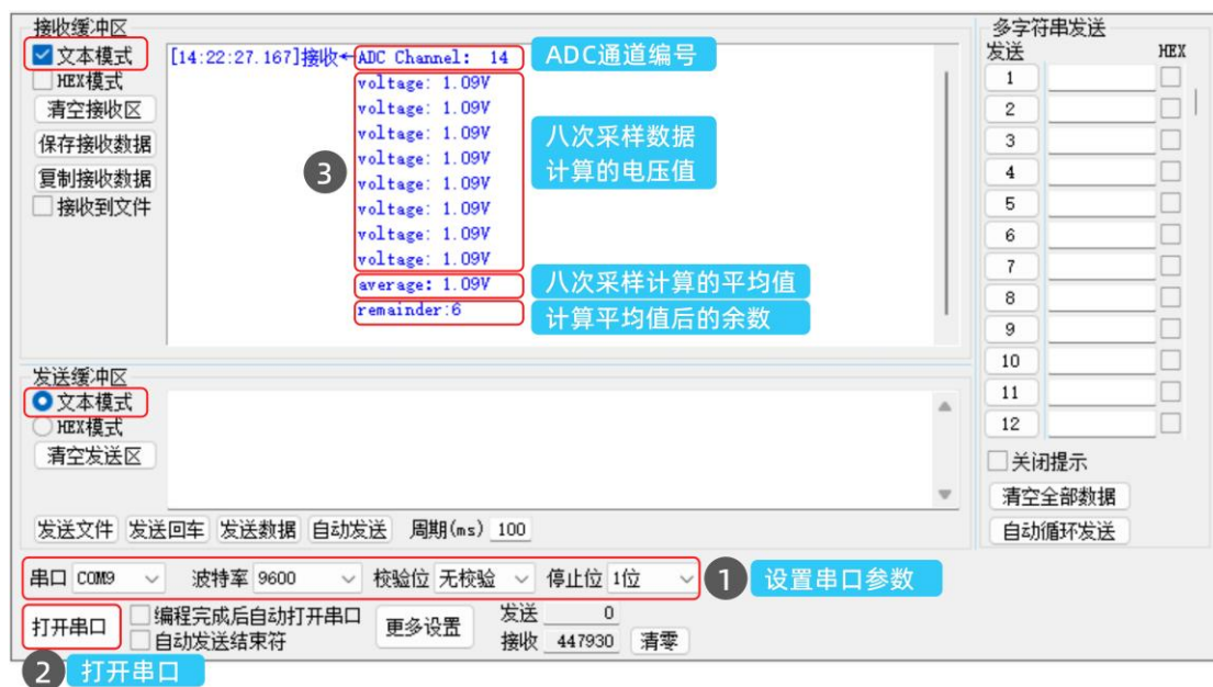
图 7：串口调试助手中观察电压值
