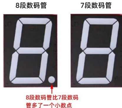
图 1：8 段数码管比 7 段数码管
