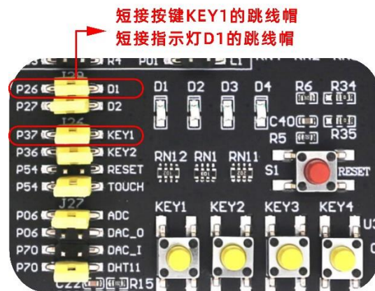
图 8: D1 和 KEY1 跳线帽短接
