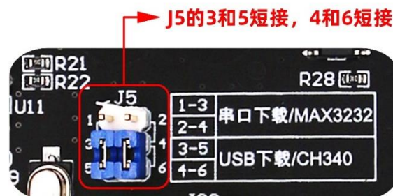
图 9: USB 转串口跳线帽短接
