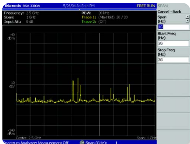
图3-3: 标准频谱分析仪模式, 显示了使用最大保持功能在1 GHz 频率跨度上进行的停播测量。
