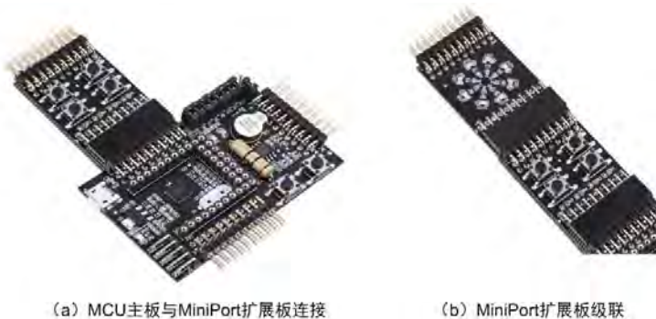
图 1.23 MiniPort 扩展板实物连接示意图
