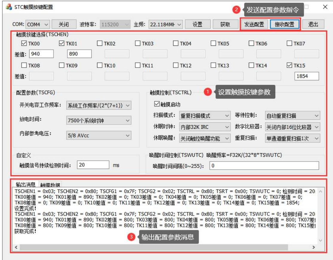
注意：触摸按键校验检测 MCU 程序固定使用 5/8 AVCC、3/4 AVCC 两个内部参考电压进行切换校验检测，防止电磁干扰。使用该固件时切换内部参考电压功能无效。
