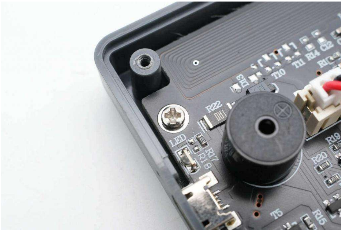
PCBA 模块采用螺丝固定在壳体内部。
