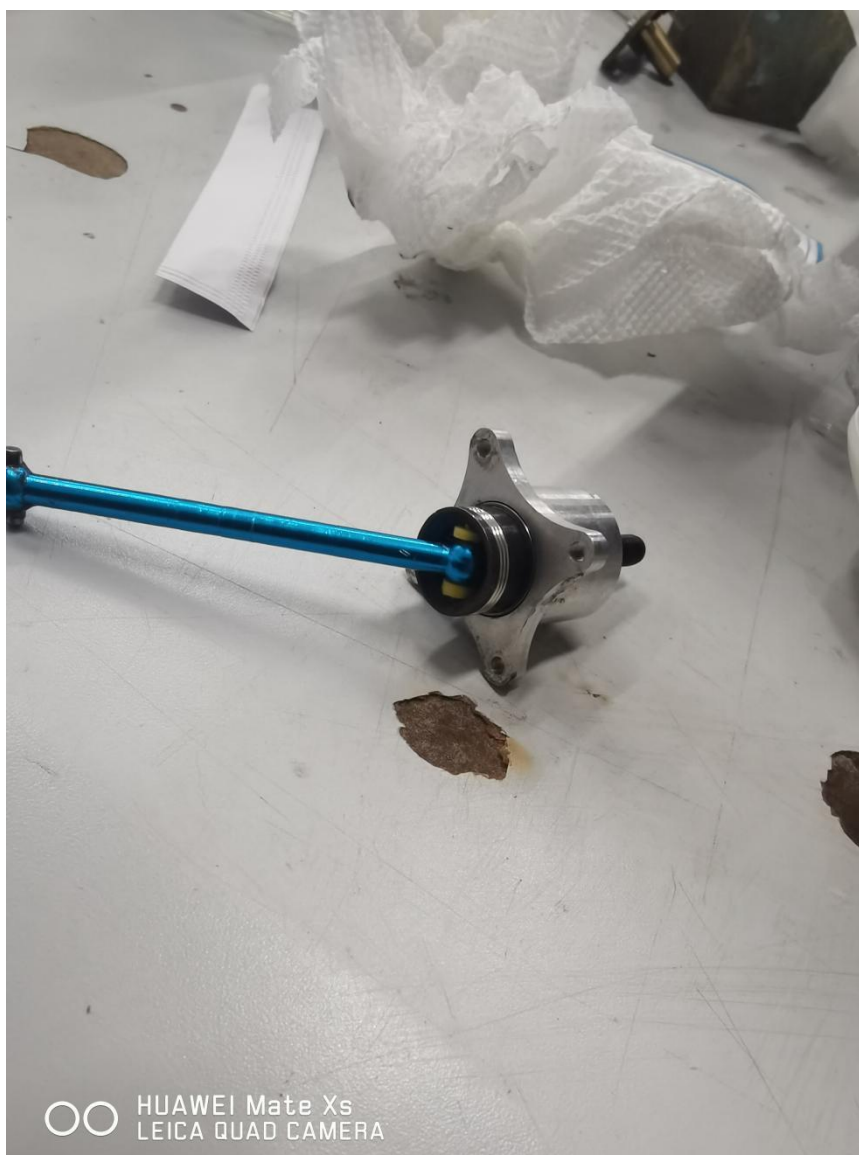
图 1-14：万向节安装方式
