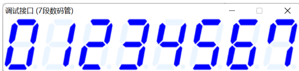
P5.4 口按键演示"ShowCode"函数输出 STC-ISP 数码管码值数据;
