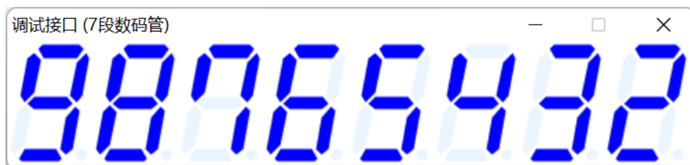
P3.3 口按键演示"ShowFloat"函数输出 STC-ISP 数码管显示的浮点数数据:
