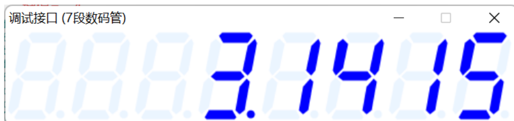
P5.4 口按键演示"ShowCode"函数输出 STC-ISP 数码管码值数据;
