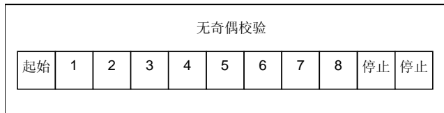
图 8: RTU 模式位序列 (无校验的特殊情况)
