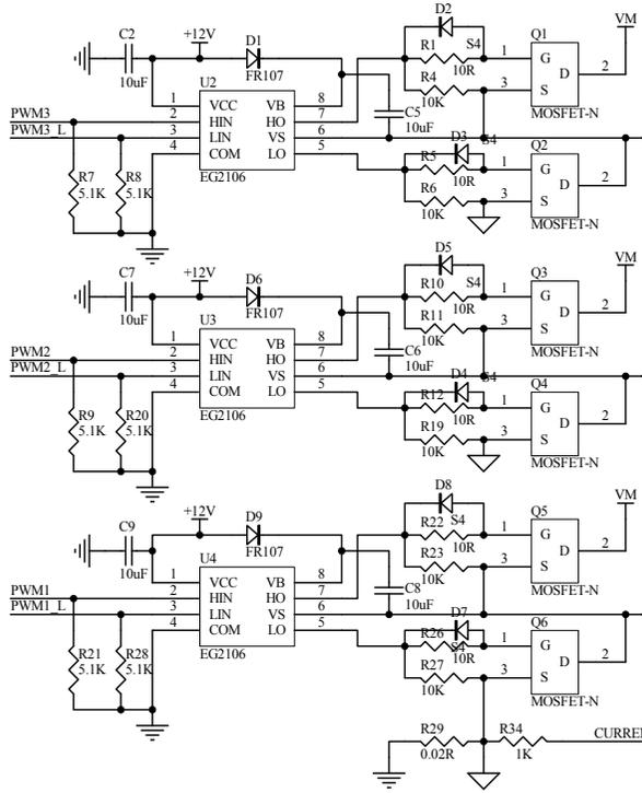
请根据电机电流自行选择高压MOSFET型号(耐压不低于500V)
